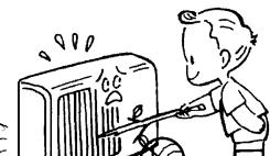
Не вставляйте посторонние предметы в воздуховыпускное отверстие комнатных и наружных блоков кондиционера. В них с большой скоростью работают вентиляторы, прикасаться к которым небезопасно.
