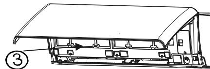
Очистку фильтров рекомендуется проводить 1 раз в месяц, при эксплуатации кондиционера в жилых помещениях, и 1 раз в 2 недели при эксплуатации в общественных зданиях, офисах, кафе и т.п.!!!
